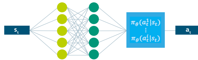
Abbildung 17: Der Handelsagent besteht aus einem Neuronalem Netz. Erhält der Agent einen neuen Input, werden die Informationen durch das Netz zu einer Policy transformiert, aus der dann eine Aktion ausgewählt wird.
