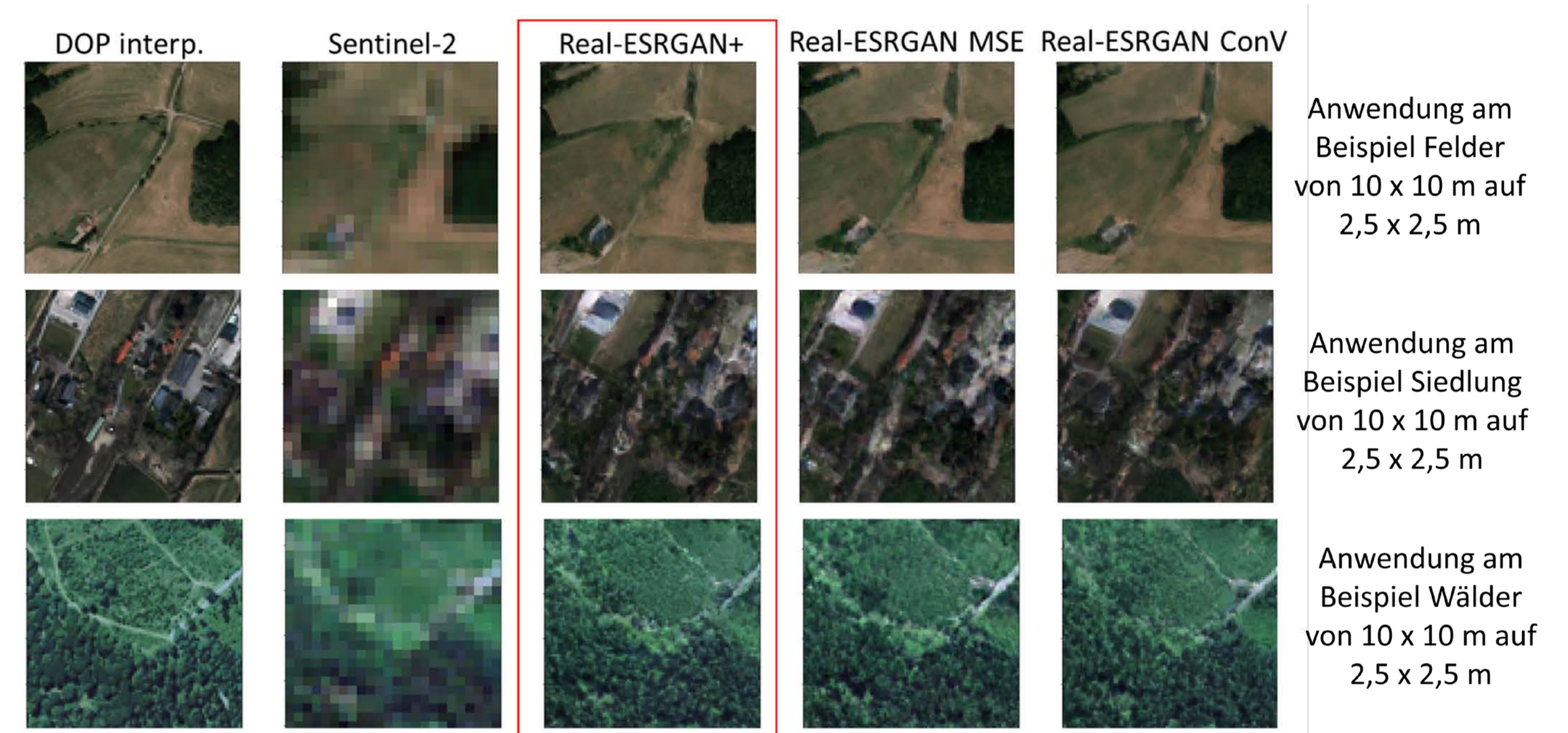
Abbildung 2: Digitale Orthophotos und Sentinel-2 Daten (links), Super Resolution Bilder für verschiedene Hyperparameter Anpassungen (rechts). (Real-ESRGAN+ entspricht den originalen Einstellungen). Bilddaten: © Europäische Union, enthält Copernicus Sentinel-2 Daten [2022] und GeoBasis-DE/BKG [2022]
